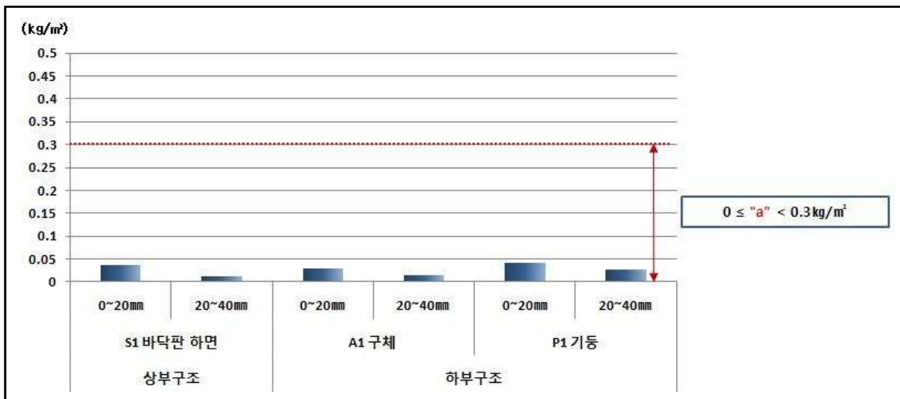
【그림 3.4.14】 염화물시험 측정결과(부산)
