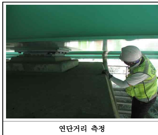
【사진 3.3.10】 연단거리 측정 전경(부산)
